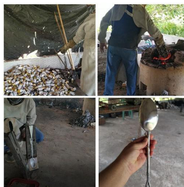
Figura 3 - Processo de reciclagem do alumínio
